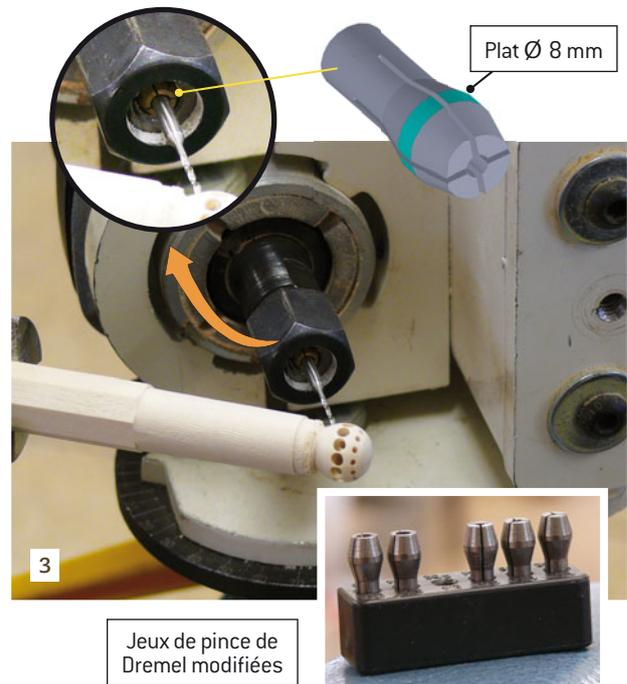
Le diamètre de 8 mm permettra de monter cette pince dans celle de la défonceuse tandis que le plat assurera le positionnement du foret dans l'axe de la défonceuse (Dessin 1). Bernard a ainsi, grâce au jeu de pince, accès à une plus grande variété de diamètres de perçage.
