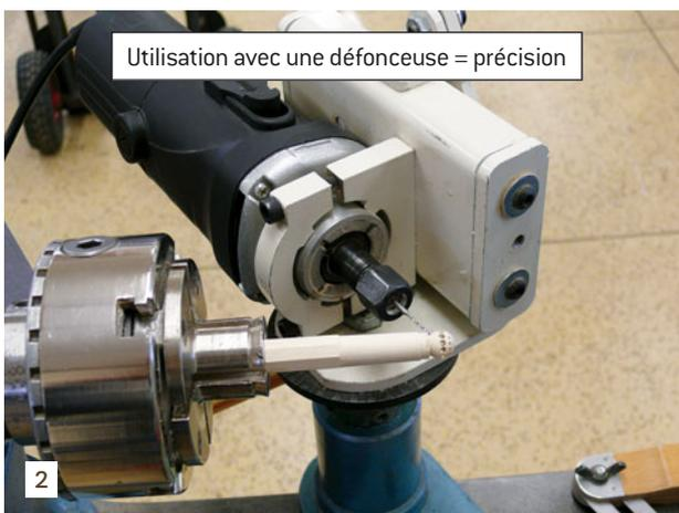
Cependant cette machine présente l'inconvénient de ne pouvoir recevoir que des forets ayant un diamètre correspondant au diamètre de la pince de défonceuse (couramment 6 et 8 en Europe). Il a contourné ce problème en modifiant des pinces utilisées sur les machines de la marque Dremel. Il a mis ces pinces
