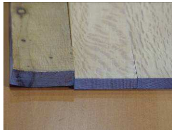
Débit sciage de chêne vert : mise en évidence des mailles, mais des déformations possibles
